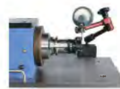
校正刀片公差 Correction insert tolerances
