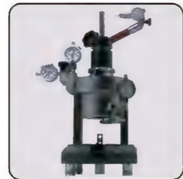
拉钉孔测量装置 the runout of pull stud hole
