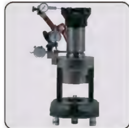
盘铣刀精度测量 runout of milling cutter
