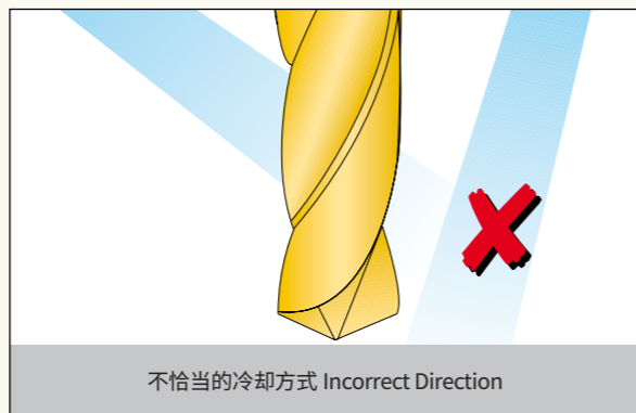
不恰当的冷却方式 Incorrect Direction
